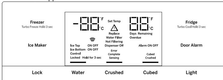
GNE29, GWE23, PWE23 Style de contrôle D, modèle sans distributeur
