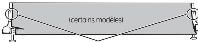
Pousser les côtés du matériau insonorisant derrière les trous de vis de fixation du coup-de-pied.
