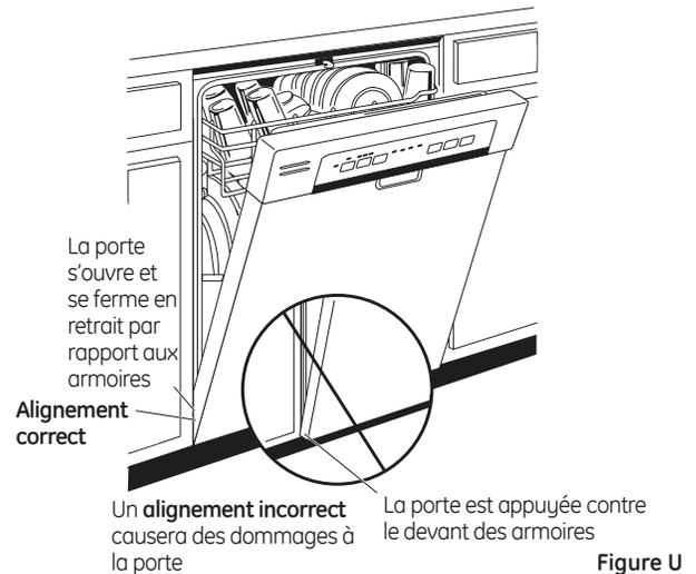
**Conseil:** Pour éviter des frais de réparation inutiles pour des dommages au panneau avant ou un problème d'efficacité de lavage.
