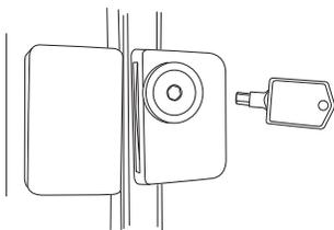
La llave del bloqueo activado por resorte es eyectado de forma automática; la llave no permanecerá en el bloqueo ya sea en la posición abierta o cerrada.
