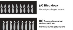
De longues flammes d'un jaune lumineux ne sont pas normales. Des flammes normales peuvent montrer des signes d'une teinte orange quand elles chauffent fort ou des signes de scintillement orange en raison de particules dans le gaz ou l'air.
