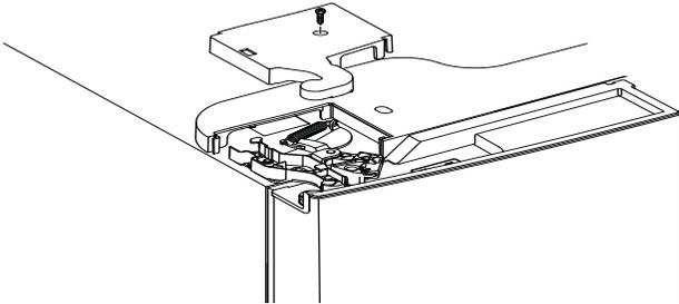
C. Débranchez les 3 connecteurs de fils et déplacez les fils jusqu'à voir les vis qui fixent la charnière. **Modèles à distributeur d'eau et de glace seulement** : Tirez sur la conduite d'eau avec précaution.
