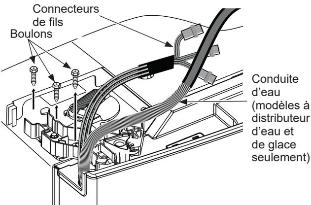
**Modèles SANS distributeur d'eau et de glace seulement** : Soulevez la charnière en ligne droite pour dégager l'axe de charnière de la douille dans le haut de la porte et acheminez le fil dans la fente de la charnière. **Modèles à distributeur d'eau et de glace seulement** : N'enlevez pas la charnière de la porte.
