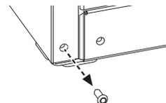
Q. À l'aide d'une clé à douille 5/16 po, posez le support de charnière inférieur et vissez les vis au couple de serrage de 60 lb-po. (6,78 Nm). Reposez la charnière et l'axe dans le trou opposé sur la carrosserie.
