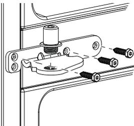
J. À l'aide d'une clé hexagonale 1/4 po, posez l'axe dans le support de charnière central.
