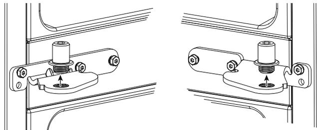
B. À l'aide d'une clé à douille 5/16 po, retirez les boulons qui fixent les supports de charnière sur la carrosserie.
