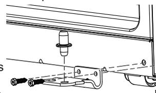
P. À l'aide d'un tournevis Torx T-20, retirez la vis de la carrosserie et posez-la du côté opposé.
