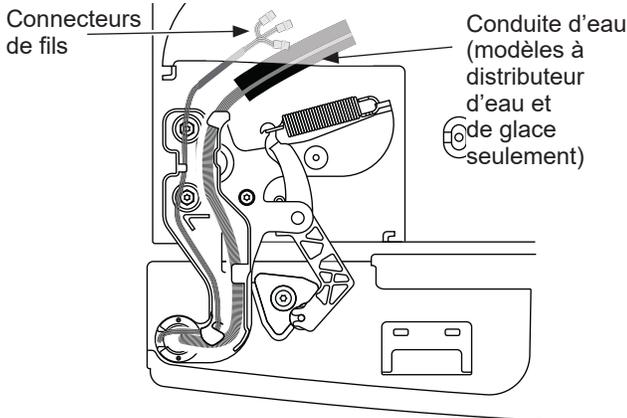
D. À l'aide d'une clé à douille 5/16 po, retirez les boulons qui fixent la charnière supérieure sur la carrosserie.
