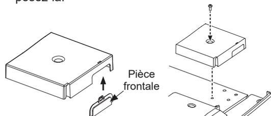
K. À l'aide d'un tournevis cruciforme et des vis fournies, posez le couvercle de charnière droit.
