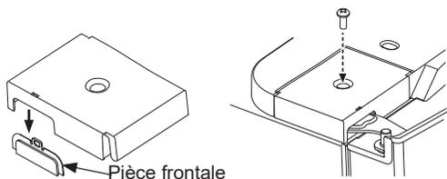
J. Posez la pièce frontale sur le couvercle de charnière droit. Posez ce couvercle à l'aide d'un tournevis cruciforme et de la vis retirée précédemment.
