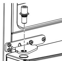
N. À l'aide d'une clé hexagonale 1/4 po, posez l'axe dans le support de charnière central. Ne laissez pas l'axe dépasser le bas du support.
