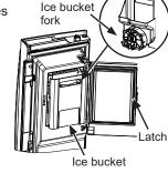
5. Si la remise en place du bac est impossible, tournez la fourchette du bac sur ¼ de tour dans le sens des aiguilles d'une montre.
