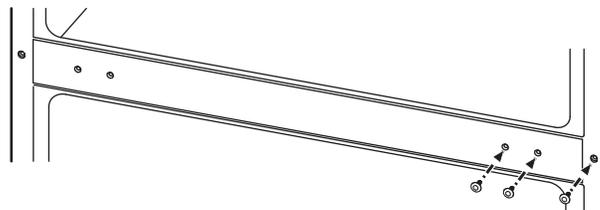
M. Retournez le support de charnière central. À l'aide d'une clé à douille 5/16 po, posez le boulon du côté gauche de la carrosserie et serrez au couple de serrage de 60 lb-po. (6,78 Nm).
