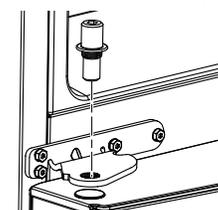
N. À l'aide d'une clé hexagonale 1/4 po, posez l'axe dans le support de charnière central. Ne laissez pas l'axe dépasser le bas du support.
