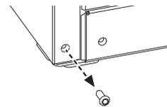
Q. À l'aide d'une clé à douille 5/16 po, posez le support de charnière inférieur et vissez les vis au couple de serrage de 60 lb-po. (6,78 Nm). Reposez la charnière et l'axe dans le trou opposé sur la carrosserie.
