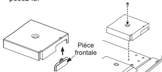
K. À l'aide d'un tournevis cruciforme et des vis fournies, posez le couvercle de charnière droit.
