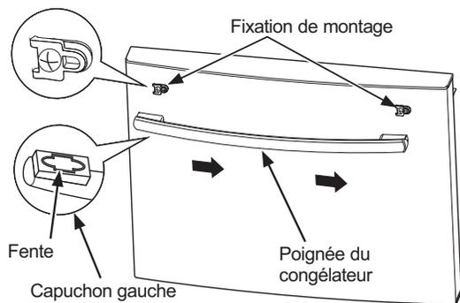
Utiliser un maillet en caoutchouc (Si non disponible, un marteau avec une serviette enveloppé au tour de la tête peut être utilisé aussi bien) pour taper doucement le côté gauche de la poignée jusqu'à ne se bouche plus de gauche à droite. **Quelques coups devraient être utilisés plutôt que l'utilisation de force lourde qui peut dommager les capuchonnes poignées.**
