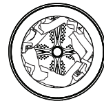
Charge de vêtements autour de l'extérieur de l'infuseur – non sur.
