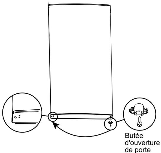
5. Aligner la partie inférieure de la porte afin que l'axe de la charnière s'insère dans l'orifice de la partie inférieure de la porte.
