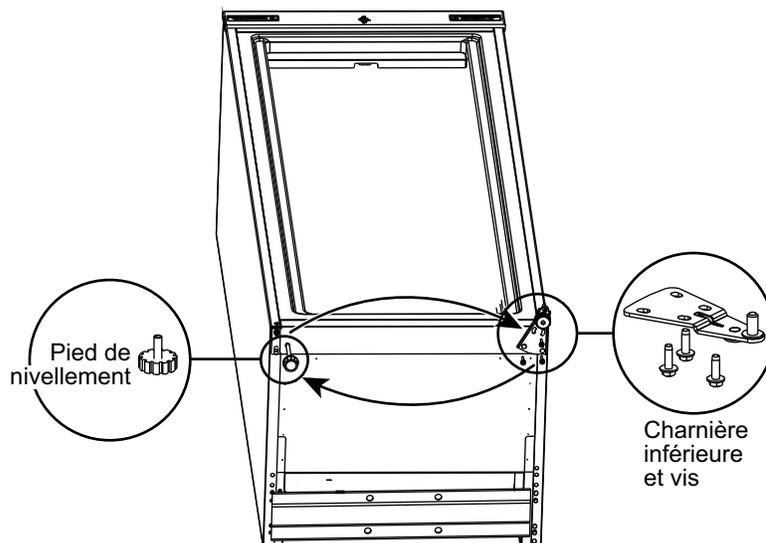
4. Retirer la butée d'ouverture de la porte, puis l'installer de l'autre côté.
